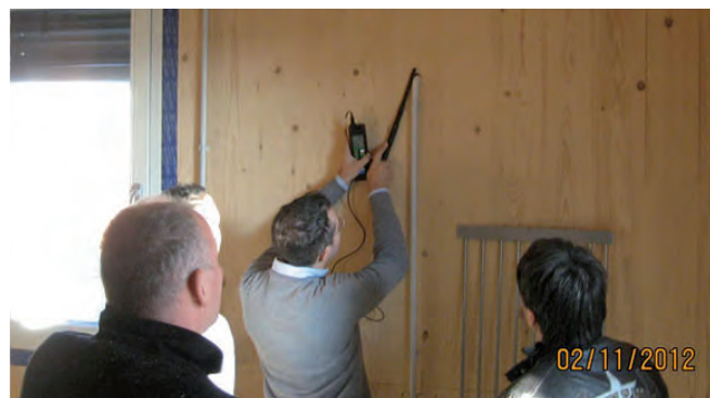
Esecuzione del Blower-door test e verifica con anemometro durante la prova in sottopressione degli spifferi d'aria in ingresso. Esecutore del BDT ing. Andrea Cagni.
