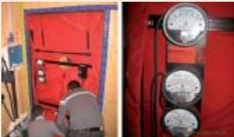
Macchina per l'esecuzione del Blower\_Door Test
